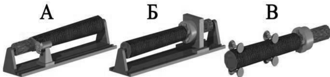
Рис. 1 - Виды оцилиндровочного оборудования по технологической схеме: А - станок позиционного типа с вращающейся заготовкой; Б - станок позиционного типа с жестко зафиксированной заготовкой; В - станок проходного типа
