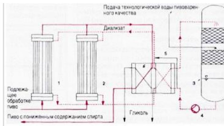
Рис. 4. Проведение диализа: 1, 2 - мембранные модули для диализа; 3 - ректификационная колонна; 4 - насос; 5 - регулирование температуры; 6 - пластинчатый теплообменник
